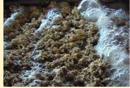
Karet dicuci dengan air dengan cairan zat kimia
