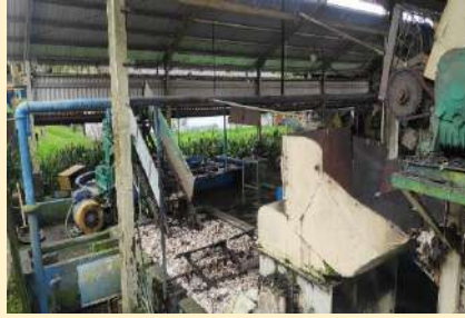
Proses pembersihan karet menggunakan mesin
